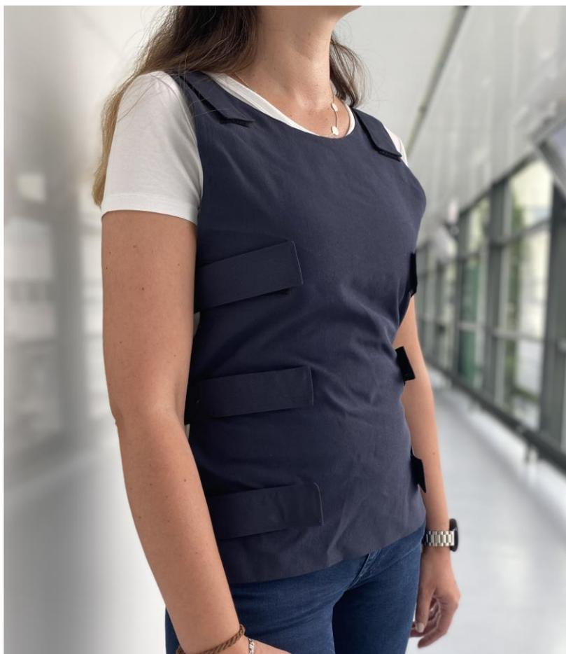
In die Vorder- und Rückseite der Textilweste sind Akustiksensoren integriert, die den Thorax abhören.
