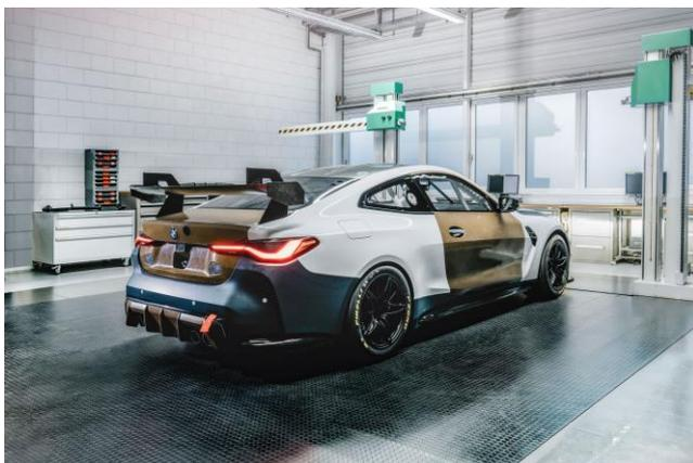
Mit der Markteinführung des neuen BMW M4 GT4 wird er das Serien-GT-Fahrzeug mit dem höchsten Anteil an Naturfaser-Komponenten sein. Die Flachfaserlösungen ampliTex™ und powerRibs™ von Bcomp finden sich im gesamten Innenraum auf dem Armaturenbrett und der Mittelkonsole sowie auf Karosserieteilen wie Motorhaube, Frontsplitter, Türen, Kofferraum und Heckflügel. Abgesehen vom Dach gibt es fast keine Bauteile aus kohlenstofffaserverstärktem Kunststoff (CFK),
