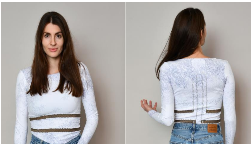
T-Shirt mit Atemsensoren: Die textilen Sensoren sind in das Kleidungsstück eingearbeitet. Bild: Empa
