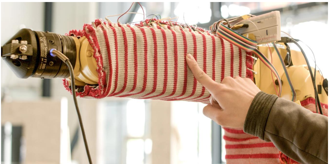
RobotSweater, entwickelt von einem Forschungsteam des Instituts für Robotik, hier an einem Roboterarm, ist eine maschinell gestrickte textile „Haut“, die Berührung und Druck wahrnehmen kann.
