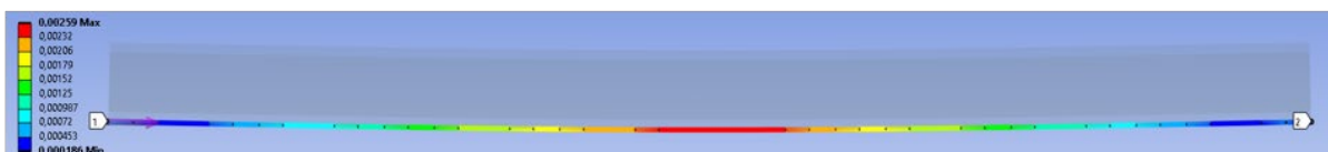
Abbildung 2: Simuliertes Dehnungs-/Stauchungsverhalten der Sensorgarne auf Druck- und Zugseite des CFK-Vierkantprofils
