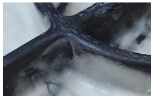
**Abbildung 4: (li.) Demonstrator Faserkunststoffverbundbauteil mit komplexer Schale/Rippen-Anordnung; (re.) Detailierung der Rippen, gerichteter Faserverstärkung von der Schale in die Rippe**
