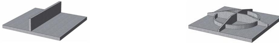
**Abbildung 1: (li.) Funktionsmuster FM1 Schale mit einer Rippe; (re.) Demonstrator Schale mit komplexer Rippenanordnung (Rippenhöhe H im Bereich 5 – 20 mm)**
